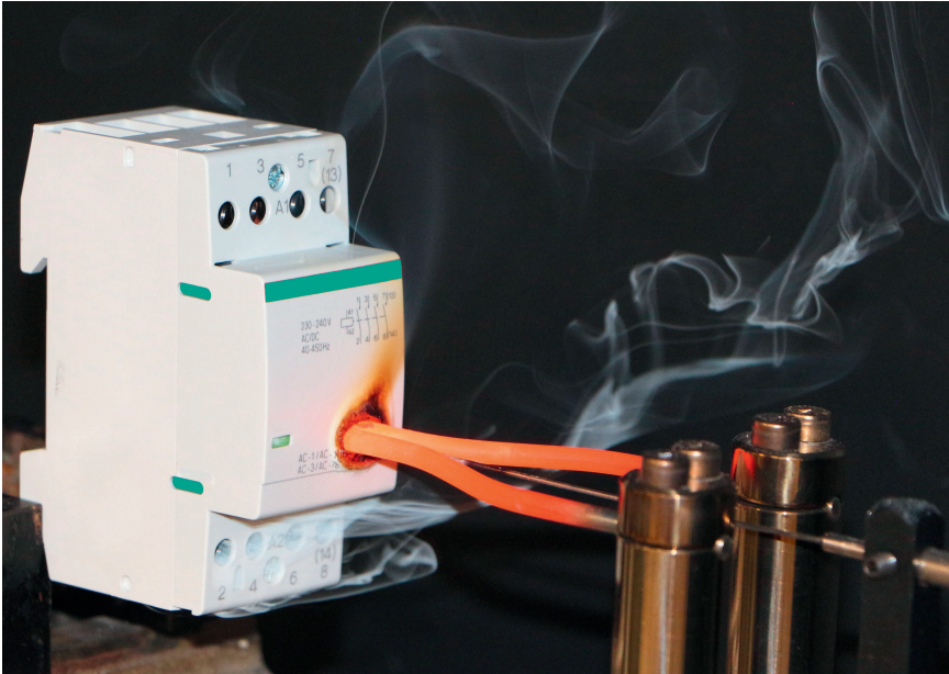
Prüfung mit einem 850 °C heißen Glühdraht an einem Schaltgerät: Führt ein Fehler beim Anschluss eines Schaltgerätes dazu, dass sich zum Beispiel ein Kabel stark erhitzt, dann muss eine eventuell entstehende Flamme selbstständig verlöschen. © Ascend
