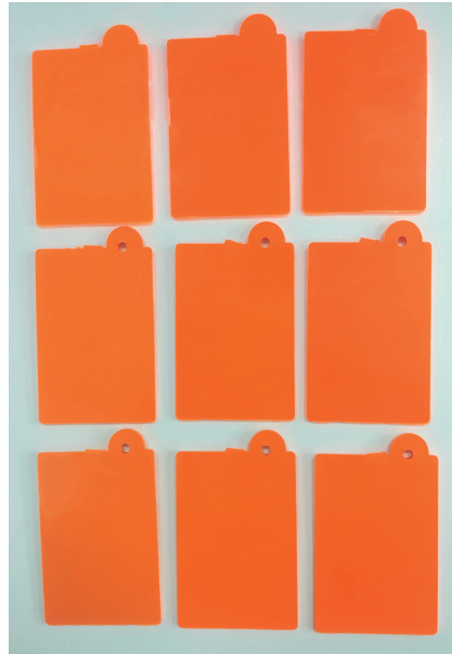
Bild 3. Probekörper in oranger Farbgebung nach Temperaturlagerungsprüfung © Ascend
